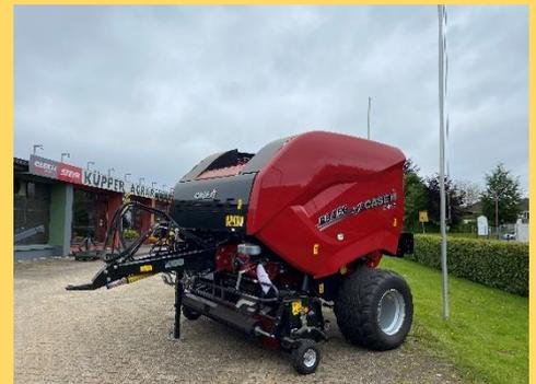
PICKUP MIT ÜBERLASTSICHERUNG EINER GESAMTBREITE VON 2,3 METER MIT
