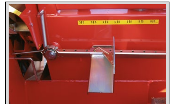
Excenter den Längsanschlag minimal vom Holz weg und ermöglicht den freien Fall in den Spaltkanal.
