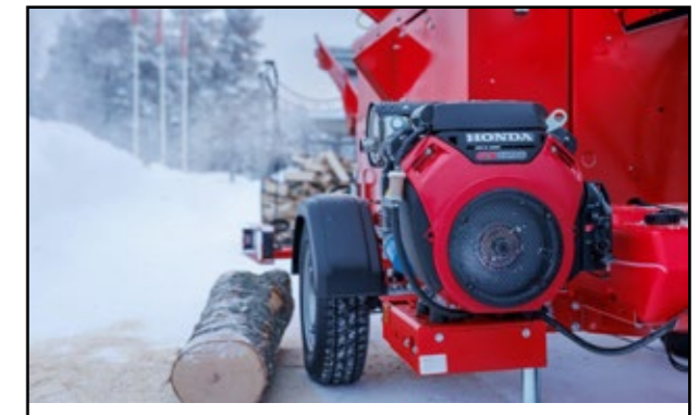
Die Maschinen sind mit einer auf die Größe abgestimmten Hydraulikanlage incl. hochwertigem Benzinmotor-Aggregat ausgerüstet.
