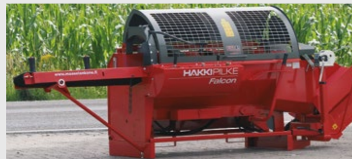
Einteilige Sicherheitsschutzhaube mit integriertem Not-Stopp (ab Modellreihe 2011)
