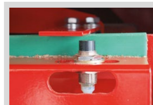
Kontaktlose Spaltersteuerung Verschleißfreier Betrieb
