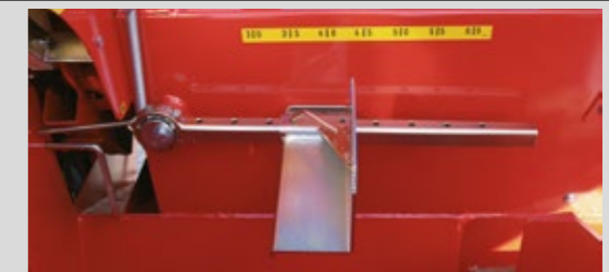
Excenter - Beim Sägevorgang bewegt ein mech. Excenter den Längsanschlag minimal vom Holz weg und ermöglicht den freien Fall in den Spaltkanal.
